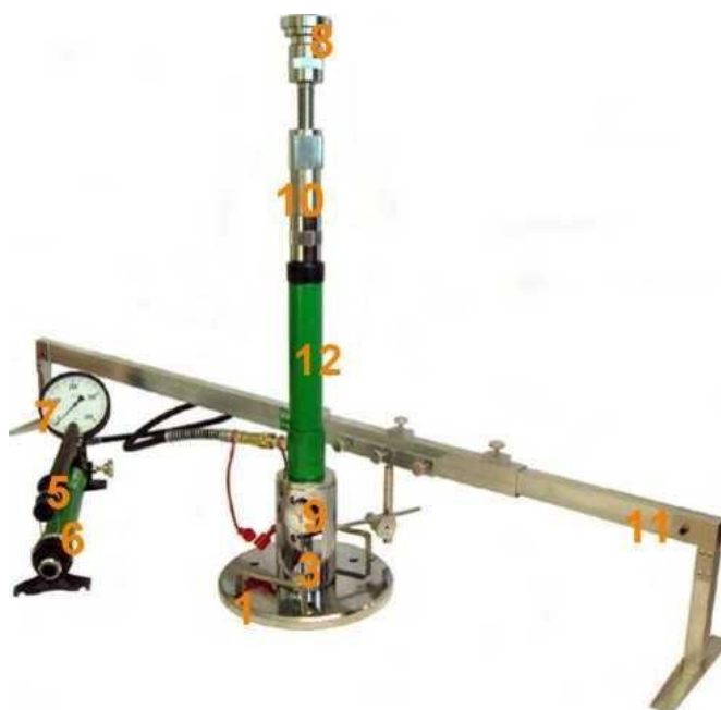
Rys. 1.2 Aparatura VSS z jednopunktowym pomiarem przemieszczenia płyty
